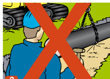
3 Metallvagnar, krokar eller kedjor får inte komma i direktkontakt med rören.
